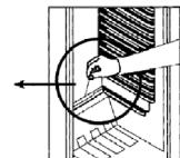
Se till att avloppsrännan och avloppsöppningen inte är blockerade så att vattnet som produceras i kylskåpet alltid kan rinna av fritt.
