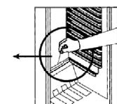
Assicurarsi che il pozzetto di scarico e il foro di scarico non siano in alcun modo ostruiti, in modo da garantire un deflusso continuo e corretto dell'acqua prodotta nel frigorifero.
