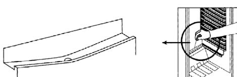
Veuillez à ce que le canal et le trou d'écoulement ne soient pas bouchés afin que l'eau produite dans la chambre froide puisse toujours s'écouler librement.
