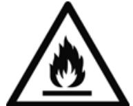
L'apparecchio contiene isobutano (R600a), un fluido refrigerante ecologico ma infiammabile. Pertanto, prestare attenzione che il sistema di raffreddamento sia protetto durante il trasporto e dopo l'installazione dell'apparecchio. Non attivare in alcun modo l'apparecchio se il sistema risulta danneggiato. In questo caso, tenere il fluido refrigerante lontano da fiamme libere e fonti infiammabili, e areare la stanza.
