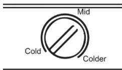
Plaats het in op een middenpositie om de optimale temperatuur in te stellen voor normaal gebruik. Hoe verder u de knop met de wijzers van de klok mee draait, hoe lager de temperatuur in het apparaat. Hoe verder u de knop tegen de wijzers van de klok in draait, hoe hoger de temperatuur in het apparaat zal zijn. Gebruik een thermometer om te controleren of de gewenste temperatuur is bereikt.
