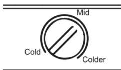
Impostare il termostato su una posizione centrale al fine di garantire una temperatura ottimale per il suo normale funzionamento. Ruotando la manopola del termostato in senso orario si riduce la temperatura all'interno dell'apparecchio. Ruotando la manopola del termostato in senso antiorario, si aumenta la temperatura all'interno dell'apparecchio. Utilizzare un termometro per assicurarsi di aver raggiunto la temperatura desiderata.
