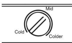
Placera den i ett centralt läge för att ställa in en optimal temperatur för normalt bruk. Ju mer du vrider ratten medurs, desto lägre blir apparatens temperatur. Ju mer du vrider ratten moturs, desto högre blir apparatens temperatur. Se till att den önskade temperaturen har uppnåtts genom att använda en termometer.
