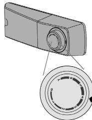
normale. Plus vous tournez le bouton dans le sens des aiguilles d'une montre (5 - 7), plus vous baissez la température dans le réfrigérateur. Plus vous tournez le bouton dans le sens contraire des aiguilles d'une montre (1 - 2), plus vous augmentez la température dans le réfrigérateur. Vérifiez avec un thermomètre si le réfrigérateur et le congélateur ont déjà atteint la température souhaitée. L'appareil est éteint dans la position 0.
