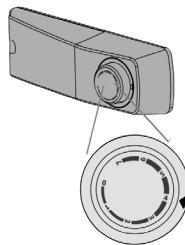
Stellen Sie ihn in eine mittlere Position (3 - 4), um eine für normale Verwendung optimale Temperatur einzustellen. Je weiter Sie den Regler im Uhrzeigersinn drehen (5 - 7), umso geringer wird die Temperatur im Kühlraum sein. Je weiter Sie den Regler gegen den Uhrzeigersinn (1 - 2) drehen, umso höher wird die Temperatur im Kühlraum sein. Überprüfen Sie das Erreichen der gewünschten Temperatur in Kühl- und Gefrierraum mithilfe eines Thermometers. In der O-Stellung ist das Gerät ausgeschaltet.
