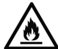
izobutan (R600a). Dlatego należy zwrócić uwagę, aby system chłodzenia był zabezpieczony na czas transportu i po zainstalowaniu urządzenia. Jeżeli system jest uszkodzony, w żadnym wypadku nie wolno uruchamiać urządzenia. W takim przypadku należy usunąć źródła otwartego ognia lub źródła zapłonu z bezpośredniego sąsiedztwa czynnika chłodzącego i przewietrzyć pomieszczenie.
