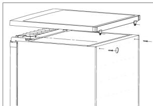
2. Retire los cuatro tornillos de la parte superior del aparato y retire la bisagra superior de la puerta (Fig. 2).
