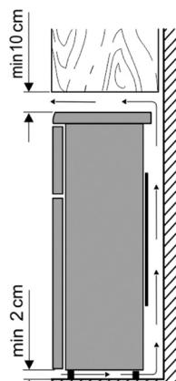
L'air chauffé à l'arrière de l'appareil doit circuler librement. De fait, la circulation de l'air ne doit pas être perturbée.
