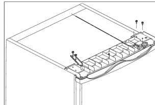
7. Sätt tillbaka apparatens skydd och skruva fast det med de två skruvarna (fig. 5).
