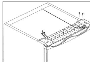
7. Vuelva a colocar la cubierta del aparato y atorníllela bien con los dos tornillos (Fig. 5).
