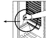
Compruebe que el canal de drenaje y la abertura de drenaje no estén bloqueados para que el agua producida en la nevera pueda siempre fluir sin impedimentos.
