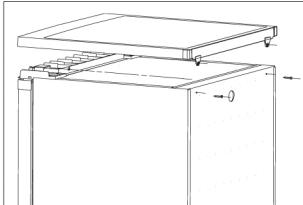
2. Enlevez les quatre vis sur la partie supérieure de l'appareil et retirez la charnière de la porte (fig. 2).
