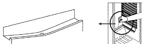
Upewnić się, że kanał ściekowy i otwór spustowy nie są zablokowane, aby woda kondensowana w lodówce mogła zawsze odpływać bez przeszkód.
