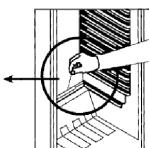
Assicurarsi che il pozzetto di scarico e il foro di scarico non siano in alcun modo ostruiti, in modo da garantire un deflusso continuo e corretto dell'acqua prodotta nel frigorifero.
