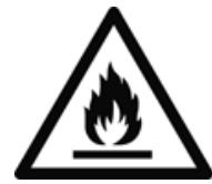
El aparato contiene isobutano (R600a) como medio refrigerante, ecológico pero inflamable. Por tanto, debe comprobar que el sistema de refrigeración esté protegido durante el transporte y después de instalar el aparato. No active el aparato bajo ningún concepto si el sistema está dañado. En tal caso, retire las fuentes de llama abierta o ignición cercanas al medio de refrigeración y airee la sala.
