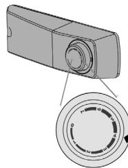
Placera den i ett centralt läge (3–4) för att ställa in en optimal temperatur för normalt bruk. Ju mer du vrider ratten medurs (5–7), desto lägre blir kylskåpsttemperaturen. Ju mer du vrider ratten moturs (1–2), desto högre blir kylskåpsttemperaturen. Se till att den önskade temperaturen har uppnåtts både i kylskåpet och i frysen genom att använda en termometer. Läget "O" betyder att enheten är avstängd.
