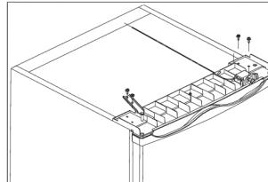
7. Posez à nouveau le couvercle de l'appareil et fixez-le à l'aide des deux vis (fig. 5).
