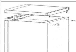
2. Wykręcić cztery śruby z górnej części urządzenia i zdemontować górnego zawias drzwi (Fig. 2).
