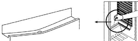
Veillez à ce que le canal et le trou d'écoulement ne soient pas bouchés afin que l'eau produite dans la chambre froide puisse toujours s'écouler librement.
