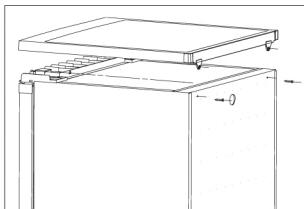
2. Ta bort de fyra skruvarna från apparatens ovansida och ta bort dörrrens övre gångjärn (fig. 2).
