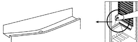
Se till att avloppsrännan och avloppsöppningen inte är blockerade så att vattnet som produceras i kylskåpet alltid kan rinna av fritt.
