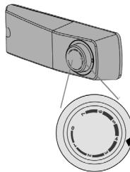
Plaats het in op een middenpositie (3 - 4) om de optimale temperatuur in te stellen voor normaal gebruik. Hoe verder u de knop met de wijzers van de klok mee draait (5 - 7), hoe lager de temperatuur in de koelkast. Hoe verder u de knop tegen de wijzers van de klok in draait (1 - 2), hoe hoger de temperatuur in de koelkast zal zijn. Gebruik een thermometer om te controleren of de gewenste temperatuur in de koelkast en de vriezer is bereikt. In de O-positie is het apparaat uitgeschakeld.
