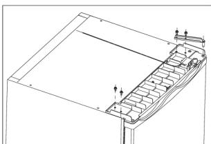
3. Levante un poco la puerta y suéltela de la bisagra inferior. Coloque la puerta en un lugar seguro.
