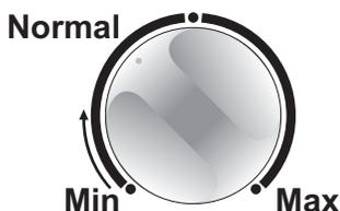
Colóquelo en una posición central para ajustar la temperatura óptima para el uso normal. Cuanto más gire la rueda en el sentido horario, menor será la temperatura del congelador. Cuanto más la gire en sentido antihorario, mayor será la temperatura. Utilice un termómetro para comprobar que se ha alcanzado la temperatura deseada.
