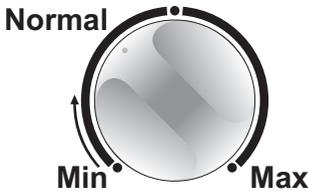
Stellen Sie ihn in eine mittlere Position, um eine für normale Verwendung optimale Temperatur einzustellen. Je weiter Sie den Regler im Uhrzeigersinn drehen, umso geringer wird die Temperatur im Gerät sein. Je weiter Sie den Regler gegen den Uhrzeigersinn drehen, umso höher wird die Temperatur im Gerät sein. Überprüfen Sie das Erreichen der gewünschten Temperatur mithilfe eines Thermometers.
