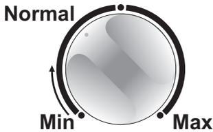
Impostare il termostato su una posizione centrale al fine di garantire una temperatura ottimale per il suo normale funzionamento. Ruotando la manopola del termostato in senso orario si riduce la temperatura all'interno dell'apparecchio. Ruotando la manopola del termostato in senso antiorario, si aumenta la temperatura all'interno dell'apparecchio. Utilizzare un termometro per assicurarsi di aver raggiunto la temperatura desiderata.
