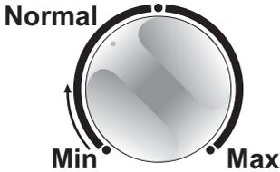
Plaats het in op een middenpositie om de optimale temperatuur in te stellen voor normaal gebruik. Hoe verder u de knop met de wijzers van de klok mee draait, hoe lager de temperatuur in het apparaat. Hoe verder u de knop tegen de wijzers van de klok in draait, hoe hoger de temperatuur in het apparaat zal zijn. Gebruik een thermometer om te controleren of de gewenste temperatuur is bereikt.
